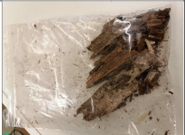
Kuvat 1 ja 2. Muottilaudat olivat lahonneita ja pinnalla oli vanhaa valkoista kasvustoa.
